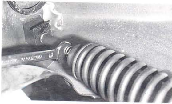
Abb. 290 Ausbau hinteres Federbein PX- Modelle: Distanzbolzen vom Silentblock abschrauben
