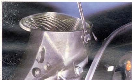
Abb. 260 Der Reflektor besitzt zwei Halter, die an der unteren Lenkerverkleidung festgeschraubt sind
