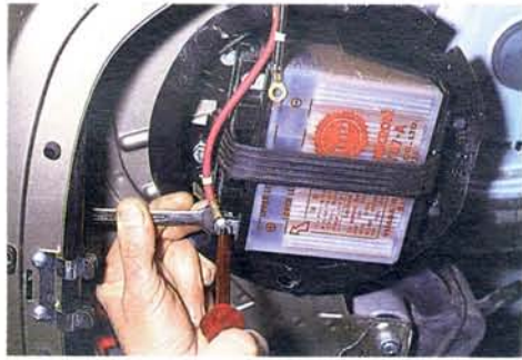
Abb. 73 Dann erst das rote Kabel vom Pluspol abnehmen; Mutter gegenhalten
