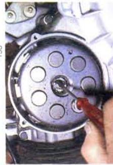
Abb. 191 Nach Abklappen des Deckels kann die Kupplung demontiert werden, der Sprengring sitzt innen
