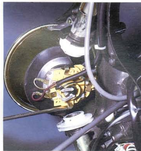
Abb. 258 Ausbau Schein- werflühlampe: die Klammern, die den Sockel hal- ten, auseinander- drücken
