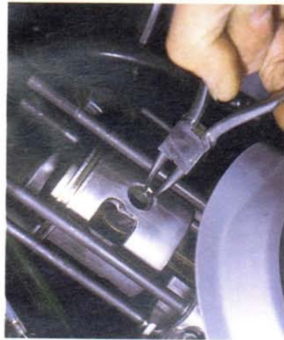
Abb. 256 Bei abgenommene- nem Zylinder kann der Kolben ausgebaut wer- den; zuerst Seegeringe am Kolbenbolzen mit einer Seegering- zange ausfedern
