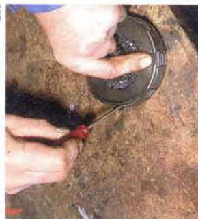
Abb. 201, 202 Kupplung von Hand oder mit Klotz und Hebel niederhalten und Sprengring ent- fernen. Anschlie- ßend läßt sich die Kupplung in ihre Einzelteile zerlegen.
