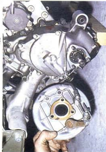
Abb. 189 Ankerplatte sei- lich wegklappen; Papierdichtung später möglichst erneuern
