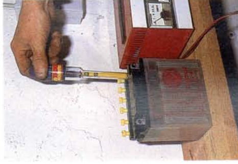
Abb. 131 Mit einem Säureheber läßt sich das spezifische Gewicht der Säure in den Zellen ermitteln
