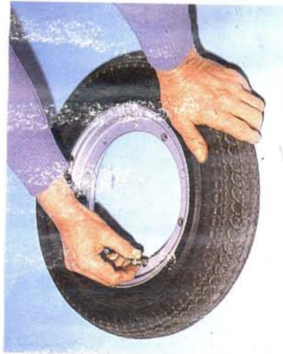
Abb. 294 Wechsel von Reifen und Schlauch – einheitlich vorn und hinten bei allen Modellen: Zuerst Luft ablassen
