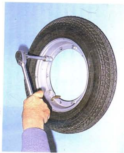
Abb. 295 Die Muttern lösen, von denen die Felgenreife zusammengehalten werden
