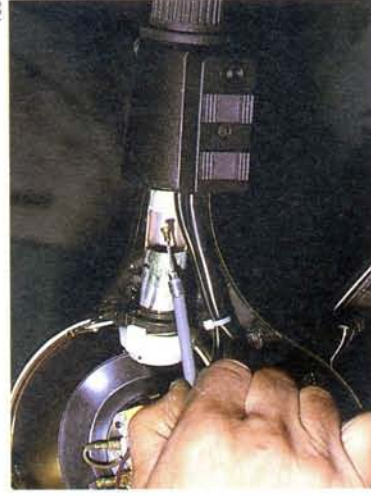
Abb. 168 Demonstration der Tachowelle:
