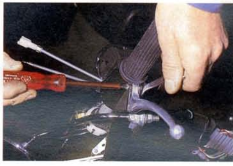
Abb. 171 Züge hochhalten und aus der Sprühdose mit Schmiermittel versorgen; fünf Minuten lang durchziehen lassen
