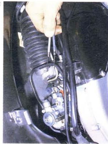
Abb. 92 Vergaserausbau PX-Modelle: Zunächst den Benzinschlauch vom Stutzen schieben Abb. 93 Bei Modellen mit Getrenntschmie- rung auch den Ölschlauch abnehmen Abb. 94 Gaszug und Starterzug mit einer Spitzzange aushängen
