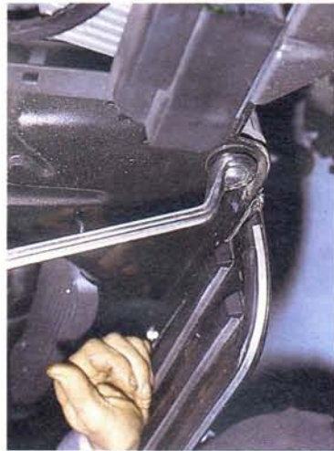
Abb. 184 Mit einem passenden Ringschlüssel die Mutter der Traversenachse lösen, Achsenkoppl auf der rechten Fahrzeugseite festhalten
