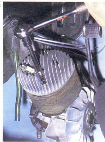
Abb. 112 Der Zylinderkopf ist bei den PX-Modellen mit vier Muttern SW 14 befestigt
