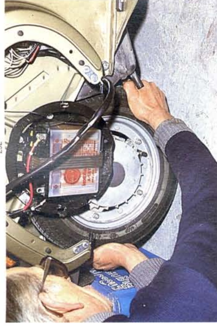
Abb. 293 Prüfung des Radlagerspiels hinten: Rad quer zur Achse hin- und herziehen
