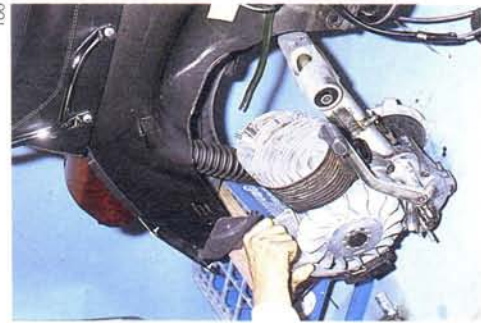
Abb. 187 Motor-/Getriebeblock (PX 200 E) komplett aus dem Fahrgestell herausnehmen
