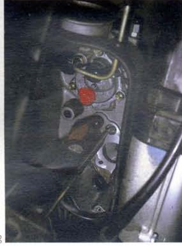
Abb. 95 Der Vergaser ist mit zwei Schrau- ben SW 11 am Motor befestigt Abb. 96 Vergaser aus dem Luftfiltergehäuse heben Abb. 97 Unter der Dich- tung sitzt die Luftfiltergehäu- se-Befestigung
