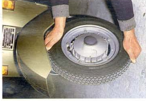
Abb. 292 Prüfung des Rad- lagerspiels vorn: das frei hängende Rad quer zur Achse bewegen
