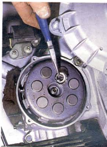
Abb. 198 Kupplungskorb blockieren und Spezialmutter mit dem Zahneisen lösen
