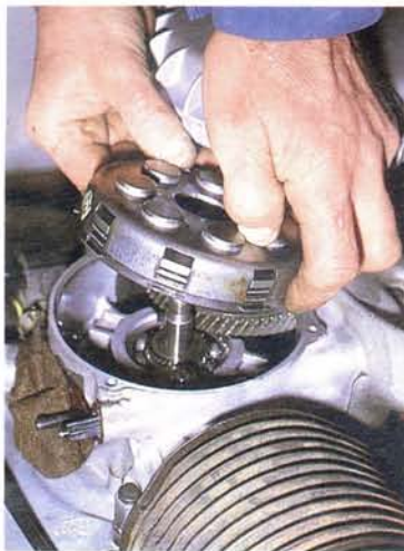
Abb. 200 Kupplungskorb komplett mit den Reib- und Mitneh- merscheiben von der Kurbelwelle abziehen
