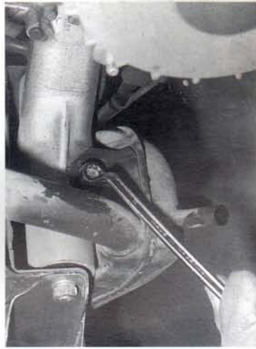
Abb. 77 Am Zylinder ist der PK-Auspuff mit zwei Muttern SW 10 befestigt
