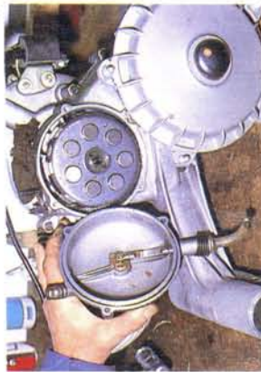
Abb. 191 Nach Abklappen des Deckels kann die Kupplung demontiert werden, der Sprengring sitzt innen
