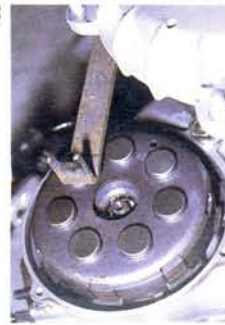
Abb. 192 Kupplungsde-montage bei den PX-Modellen - Motor ausgebaut: Der Kupplungs-deckel ist mit drei Schrauben SW 10 befestigt
