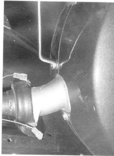
Abb. 287 Das vordere Federbein ist unten stets mit zwei Schrauben und gegenmuttern SW 13 befestigt
