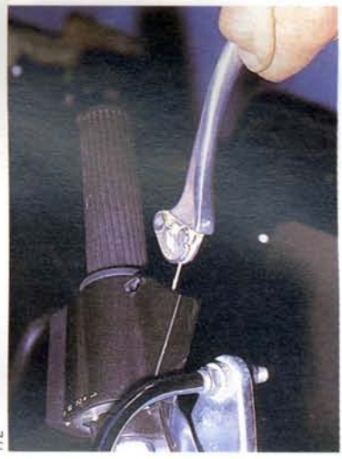
Abb. 173 Beim Abziehen des Hebels auf die Distanz- scheiben ach- ten, Nippel vom Zug abnehmen
